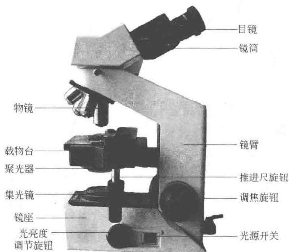
图 1-1 普通光学显微镜结构
