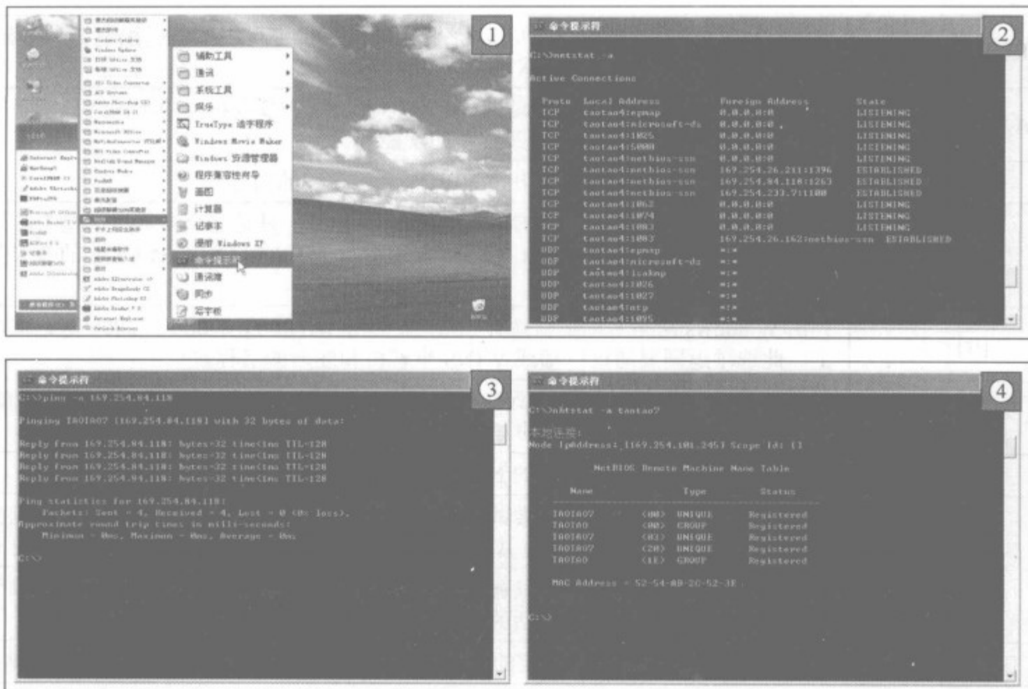
图 6-78 Netstat/Nbtstat 命令的基本使用方法
