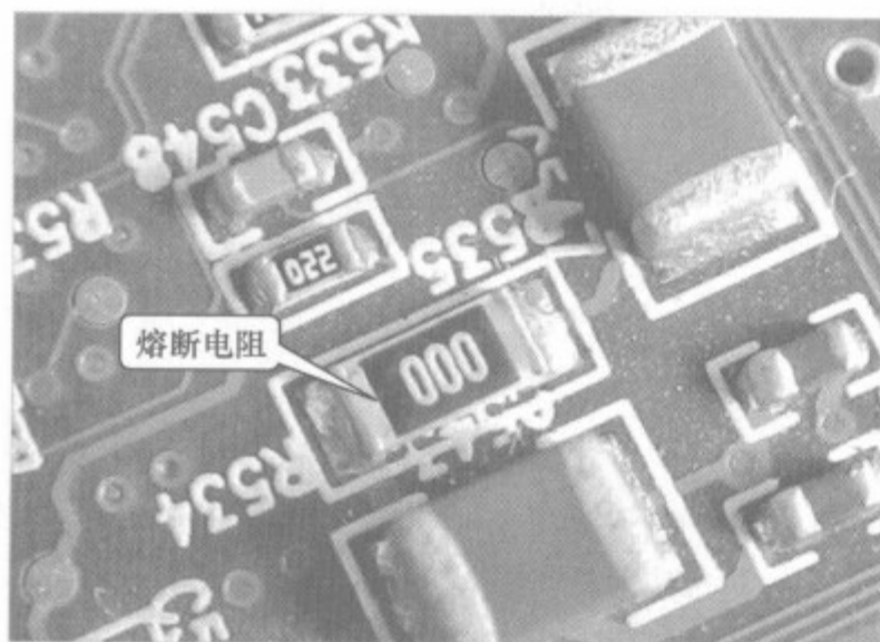
图 2-3 熔断电阻 ( 0\Omega 的贴片电阻)
