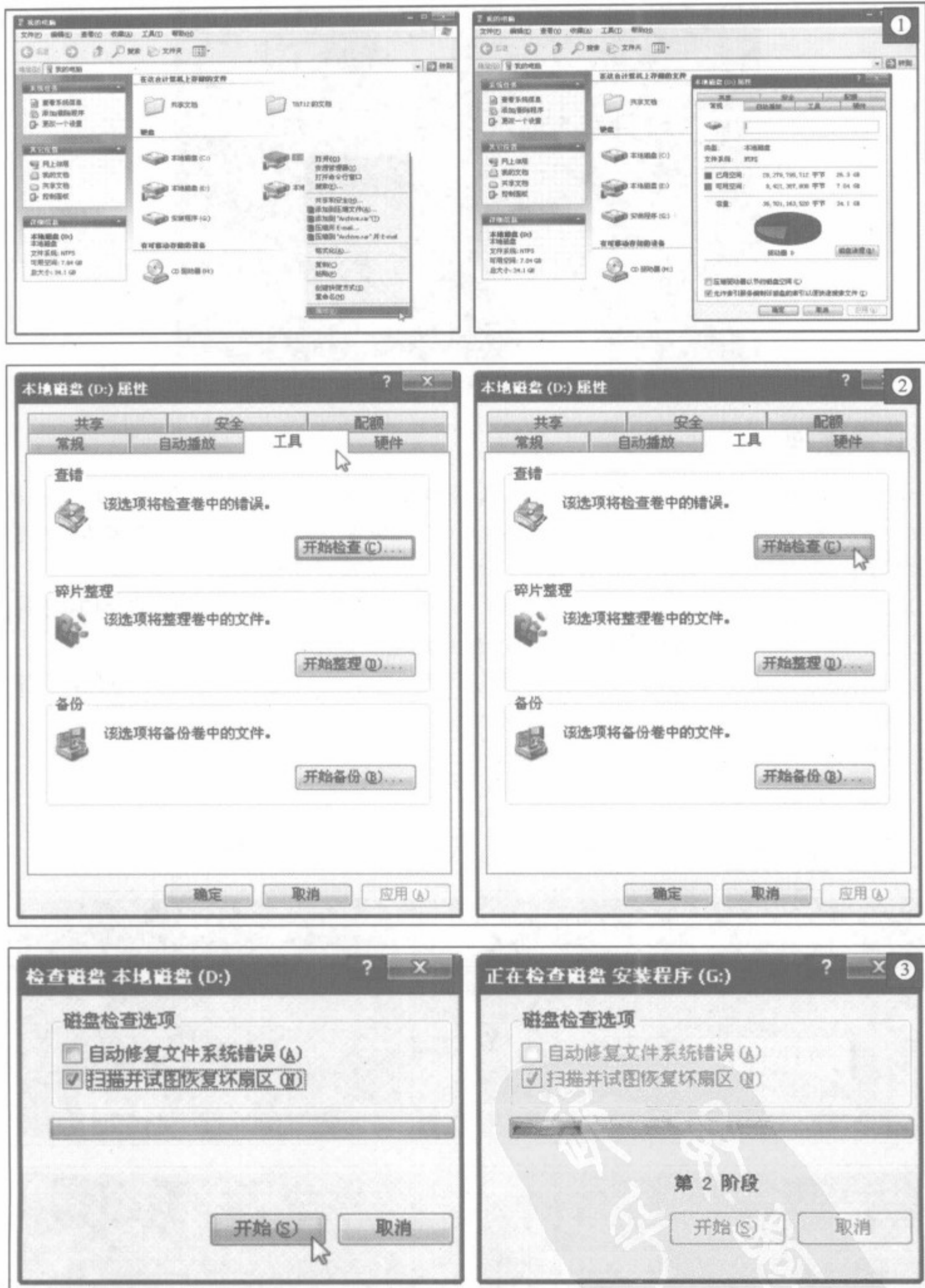
图 6-11 硬盘逻辑坏道的检测和修复方法
