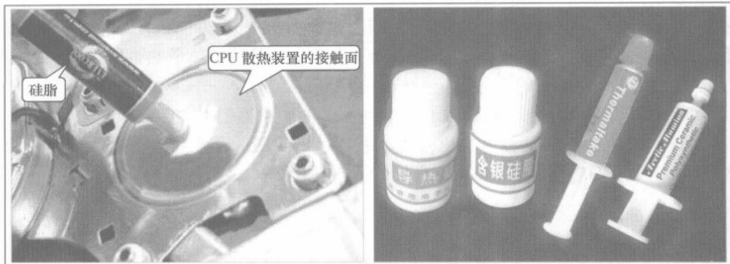
图 5-7 导热硅脂的检查方法
