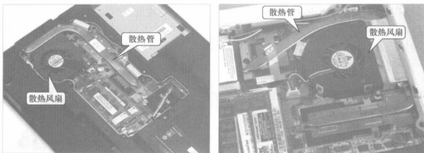
图 3-54 笔记本电脑的散热管
