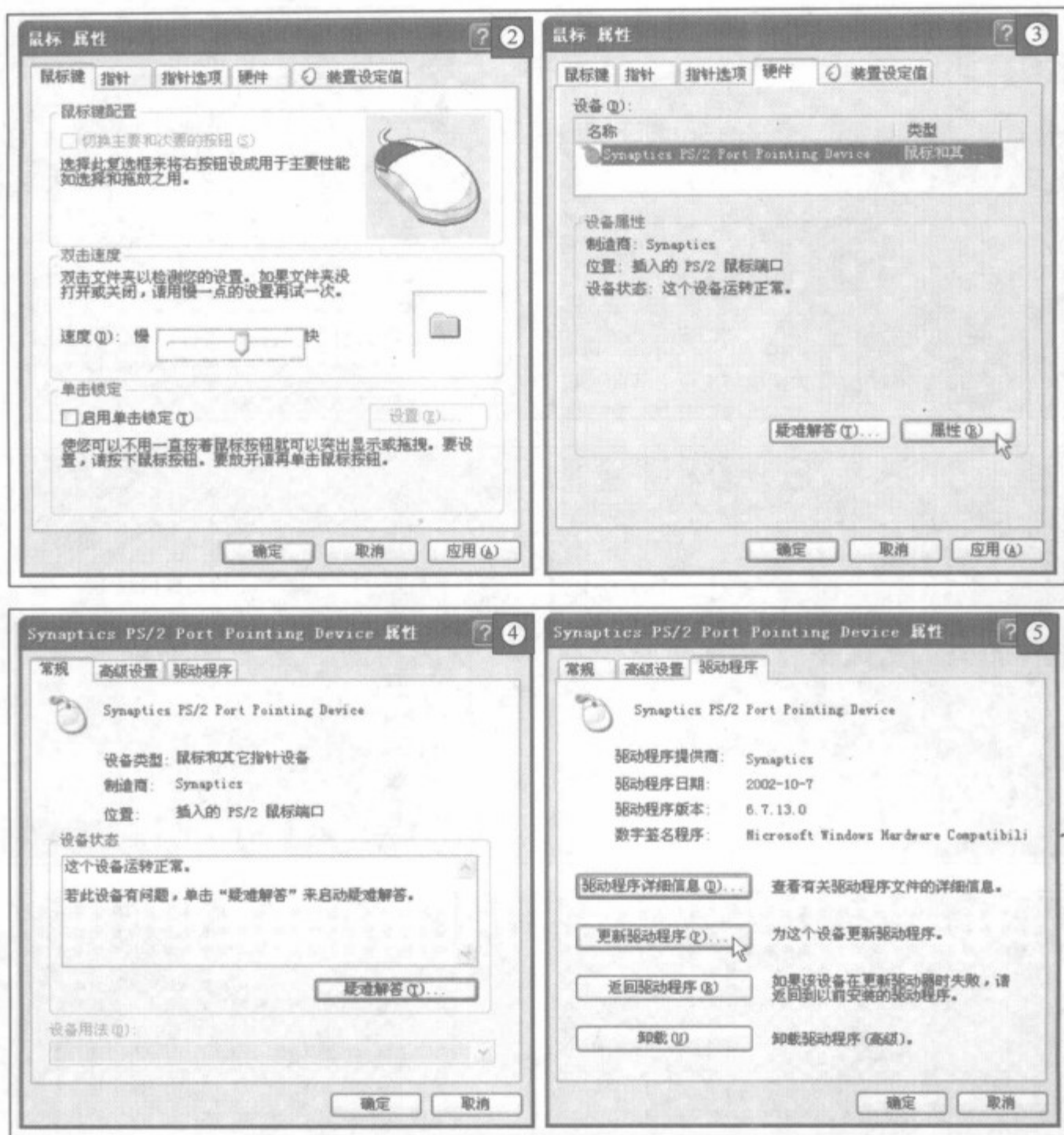
图 6-63 笔记本电脑触摸板软件故障的检修方法（续）
