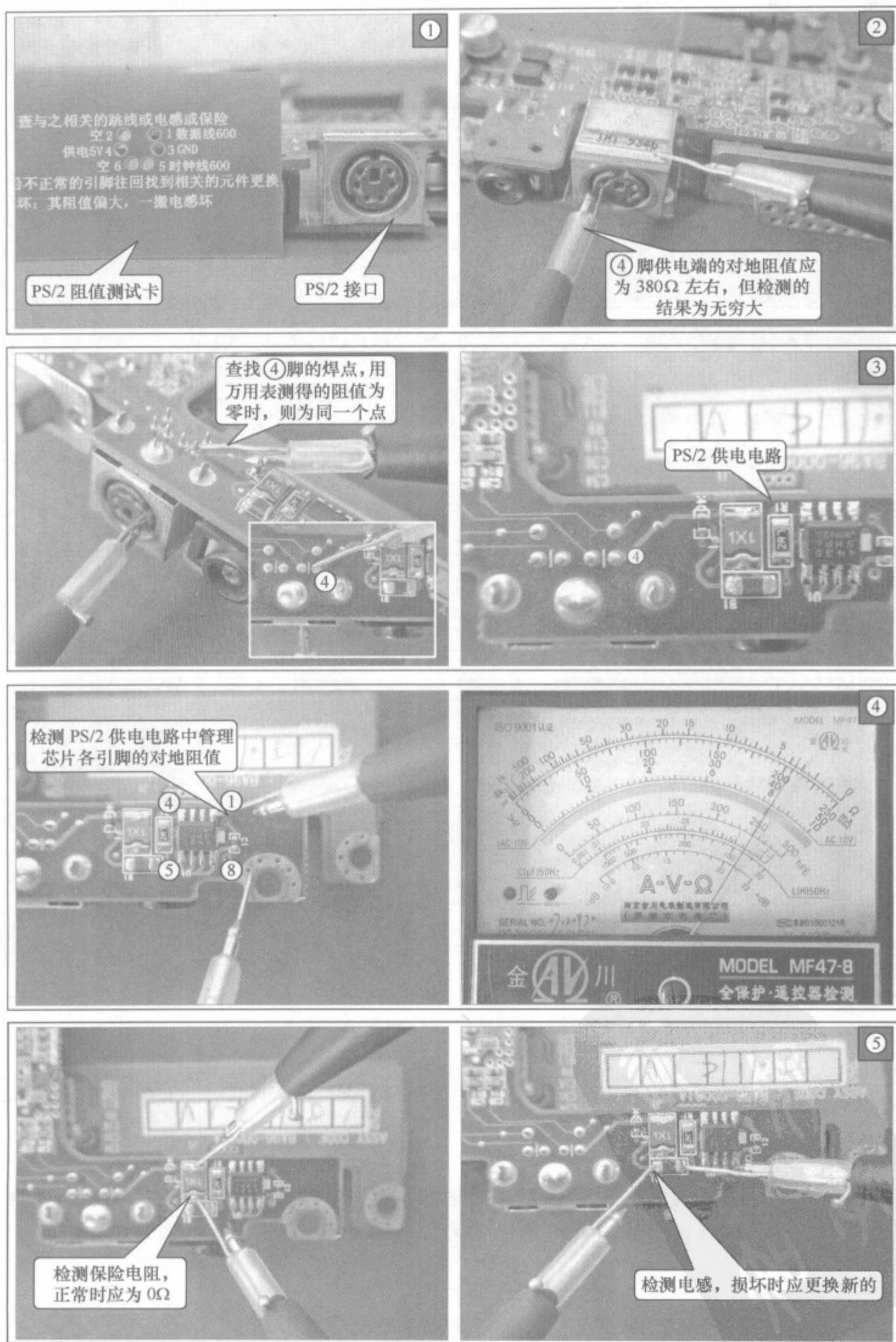
图 7-19 鼠标接口的检测方法
