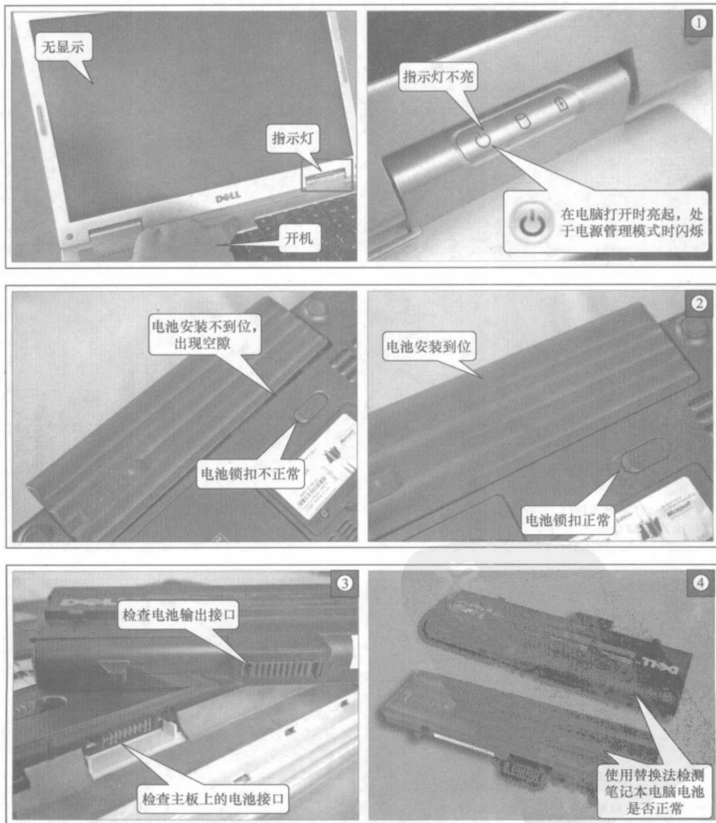
图 6-56 电源供电电路的检修方法
