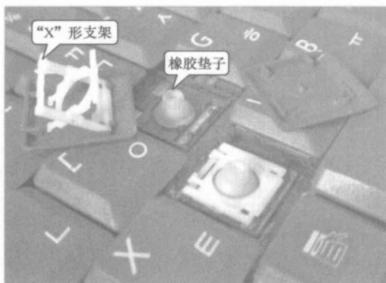
图 3-64 笔记本电脑键盘的实物拆解图
