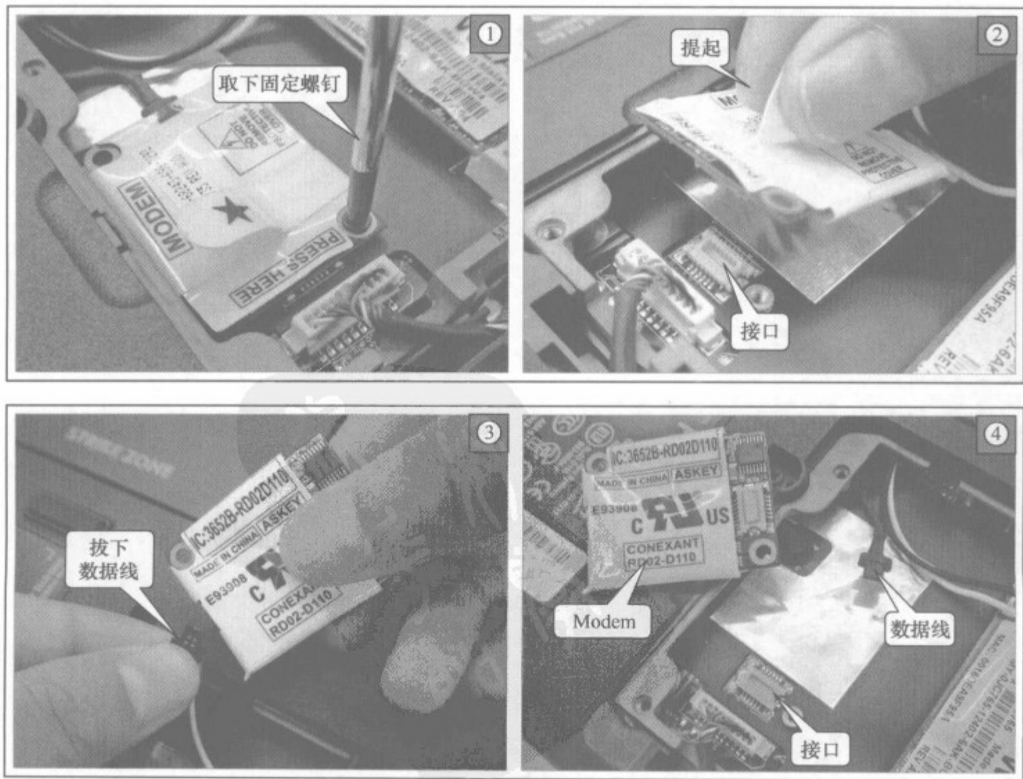
图 6-37 Modem 的拆卸方法
