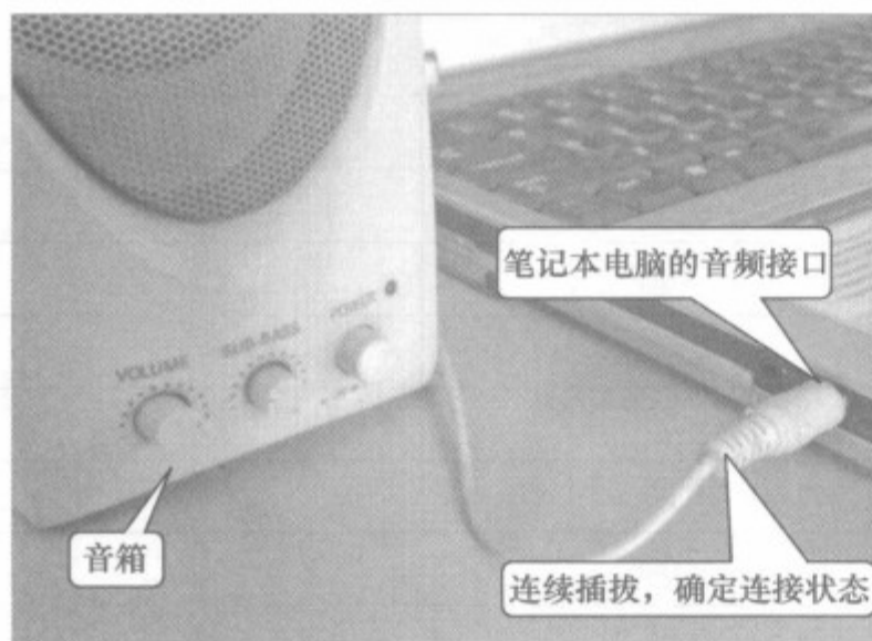
图 7-21 确定音箱与笔记本电脑之间的连接状态
