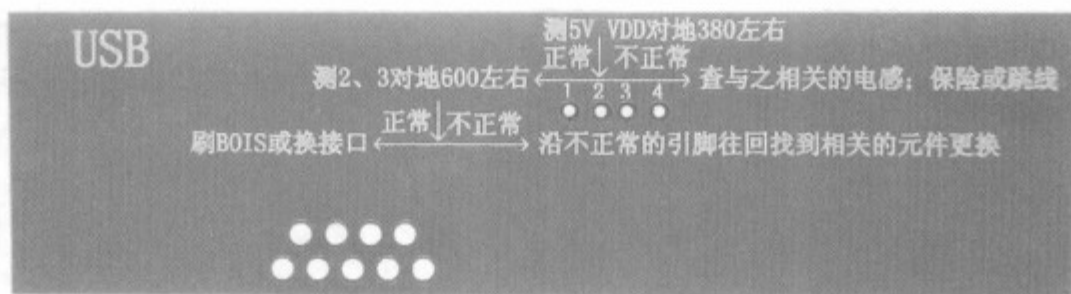
图 6-95 USB 接口打阻值卡
