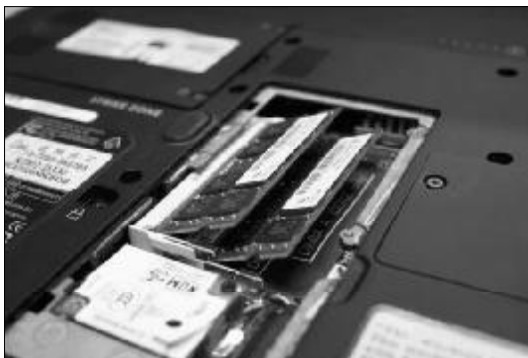
◆图 3-36 内存条松动会导致笔记本电脑无法启动
