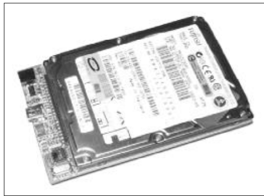
◆图 6-42 移动硬盘内部结构
