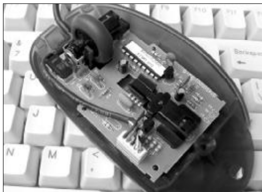
◆图 6-41 光电鼠标内部结构
