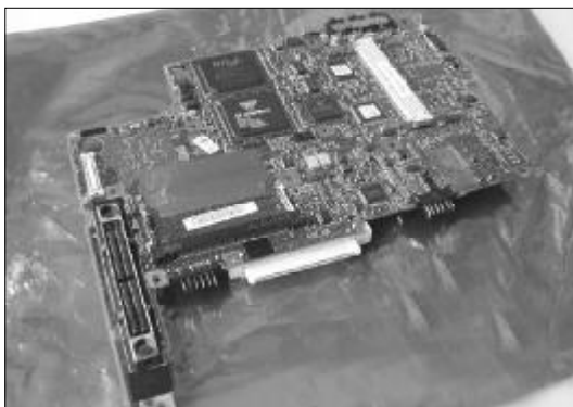
◆图 3-13 IBM T21 笔记本电脑主板
