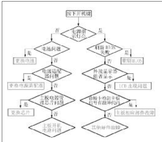
◆图 6-13 主板故障维修流程图
