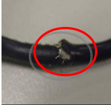
压线之后导致的线缆破雷
