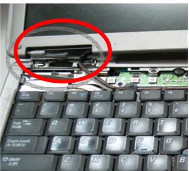
拎屏幕顶盖导致的转轴损坏
