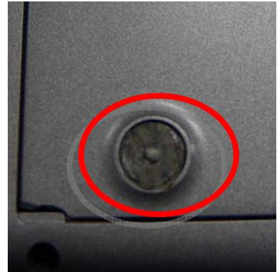
平推导致的脚垫脱落
